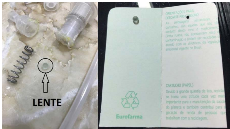
Figura 1. Modelo de microscópio artesanal construído com estrutura de papelão e lente esférica de vidro retirada de embalagens de sabonete líquido.
