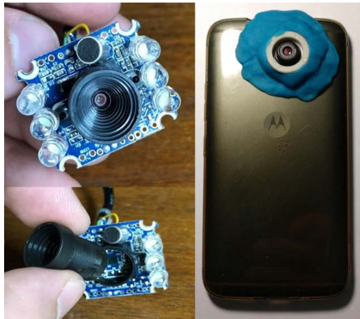
Figura 3. Modelo de microscópio artesanal construído com lente de webcam acoplada ao celular com massinha de modelar.
